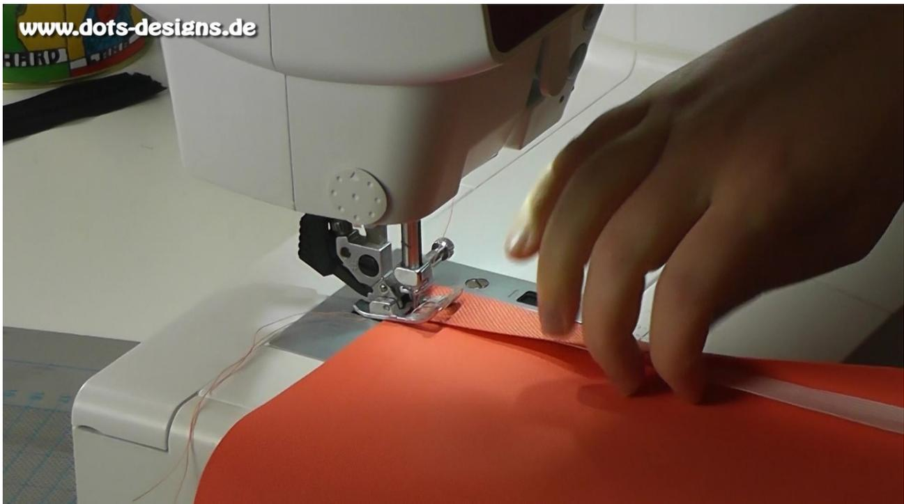
Bei dem Flaschenhalter klappst Du die lange Seite um ca. 2cm nach innen. Dann misst Du die Breite von dem Zwischenteil/ Boden Schnittmuster. Denn solange muss das Gummiband sein. Dann vernähst Du die lange Seite und dazwischen kommt das Gummiband, dass wird aber NICHT mit vernäht.
