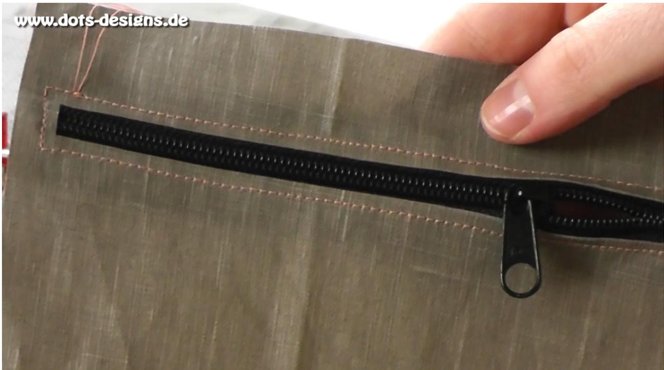
Nun legst Du den Reißverschluss von der linken Seite auf die Innentasche. Dann nähst Du von aussen mit einer Stichlänge von 3mm den Reißverschluss fest. Hierfür habe ich auch einen Reißverschlussfuß verwendet. Dann klappst Du oben die Kante und unten die Kante um ca. 1cm nach innen und bügelst sie.
