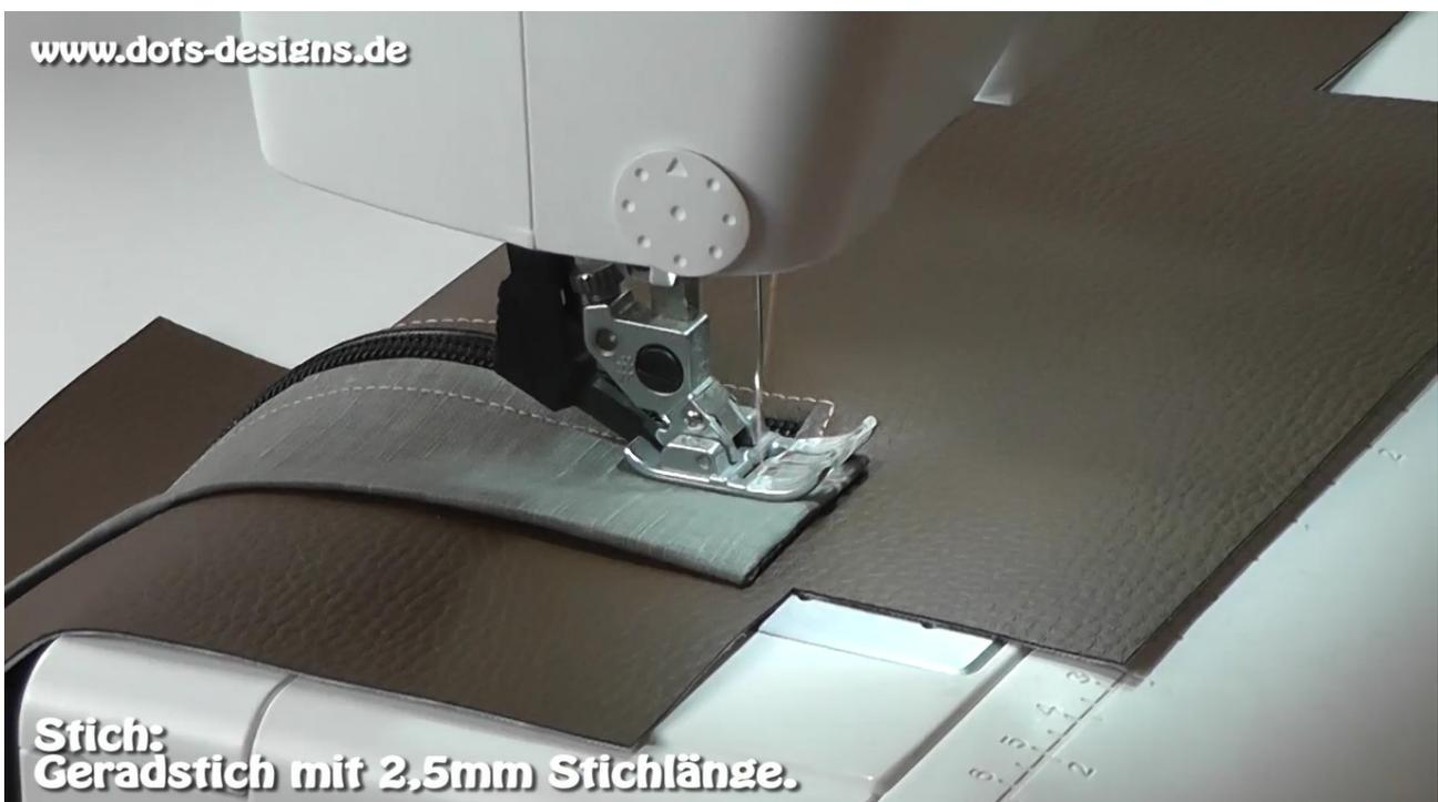
Nun legst Du die Blende auf die obere Kante vom Reißverschluss, dann legst Du die Blende mittig über den Reißverschluss und vernähst die Blende mit einer Nahtzugabe von 7mm fest.
