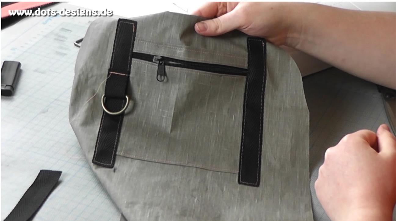
Nun benötigst Du das Nahtband und einen D-Ring. Das Nahtband habe ich jeweils oben und unten um ca.1 cm länger gemacht, als die Innentasche. Dann vernähst Du das Nahtband links und rechts fest. Für den D-Ring habe einfach eine Schlaufe aus dem Gurtband gemacht und den D-Ring dazwischen gelegt und mit an dem Nahtband vernäht.
