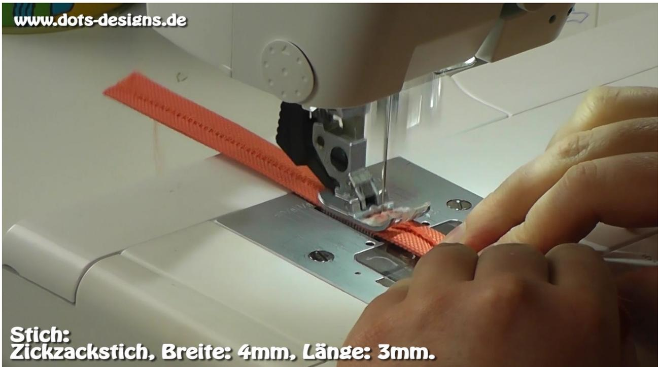
Nun „drückst“ Du die gerade genähte Naht nach unten und nähst mit einem Zickzackstich drüber.
