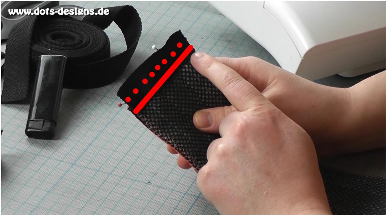
Damit das Nahtband nicht ausfranst, flambierst Du die Enden mit einem Feuerzeug. Dann legst Du das Nahtband wie auf dem Foto zusehen ist, auf den Schultergurt. Die gestrichelte Linie ist die Mitte vom Nahtband. Dann vernähst Du das Nahtband knapp am Rand ( durchgezogene Linie) einmal fest.
