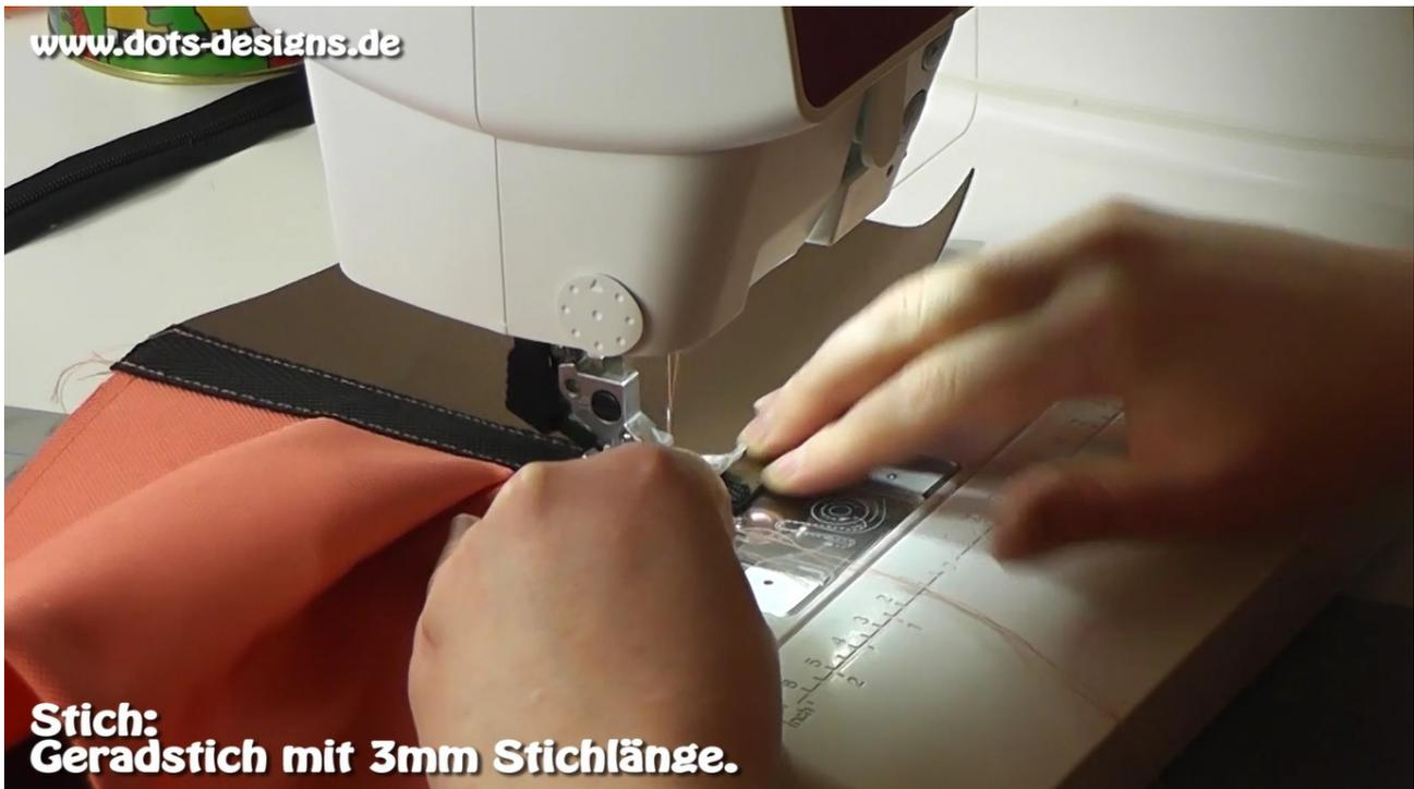
An der unteren Kante nähst Du auch ein Nahtband dran.
